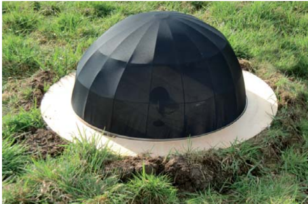
Mikrofon mit Windschirm am Messort
