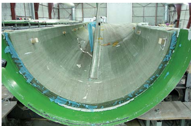
Rotorblatt in der Fertigung
